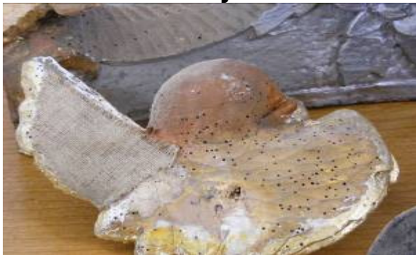
Fot.3. Drobne uszkodzenia drewna na skutek działania owadów
